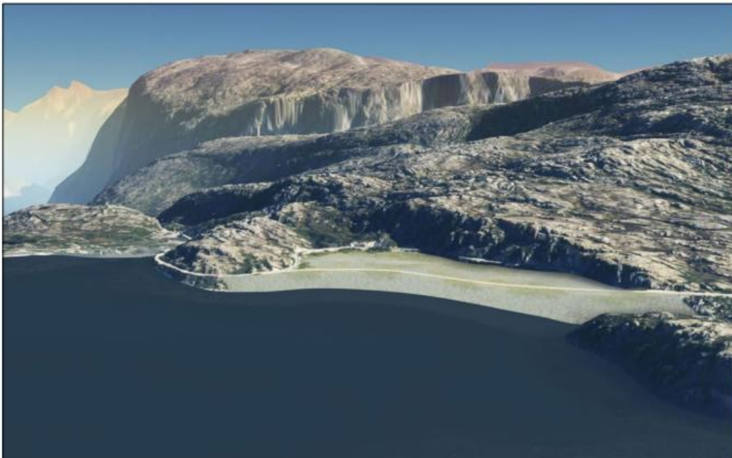
Figur 19. Visualisering av prinsipp-løsning for varig deponi i Holbuvatnet og ny varig omlegging av Aursjøvegen over deponiet, med Holbuvatnet på HRV og gjennomført tiltak for revegetering. Se vedlegg 8 for flere visualiseringer. Visualisering: Sweco.
