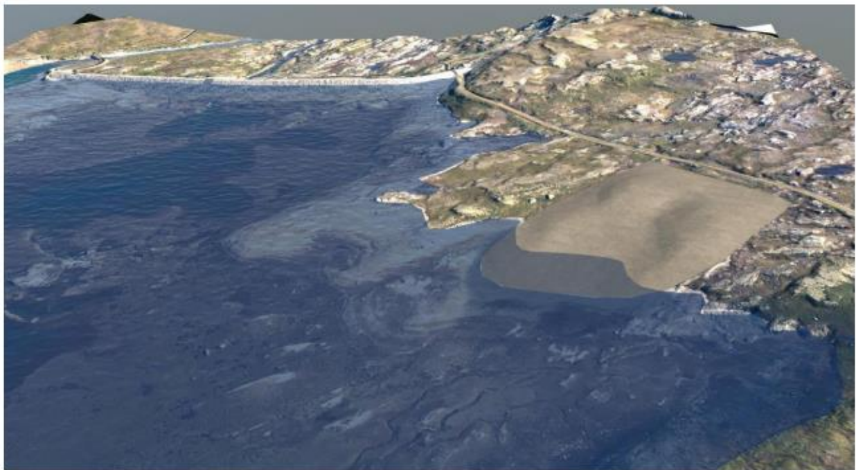
Figur 4-4. Utklipp av 3D-modell som viser steinbrudd etter istandsetting ved høy vannstand i magasinet (ca. kote 892).
